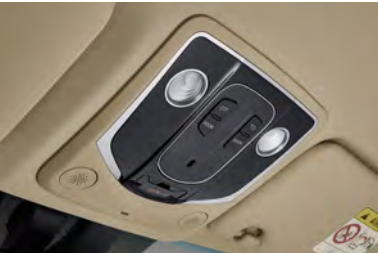
Tetőkonzol térképolvasó lámpákkal (és napfénytető vezérlő kapcsolókkal)
