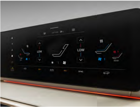
Kétfónás, automatikus klímaberendezés
