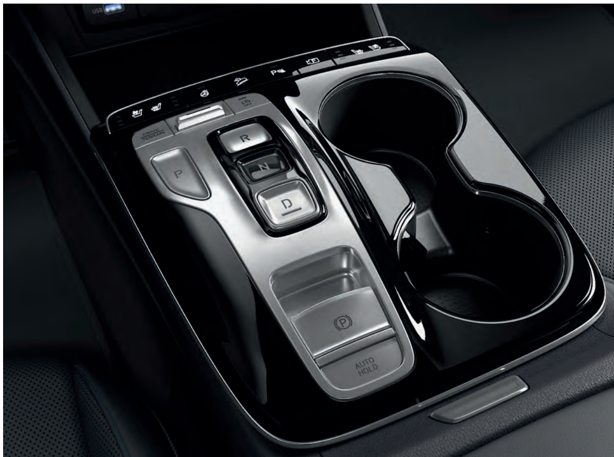
Nyomógombos, elektronikus váltóvezérlés.
