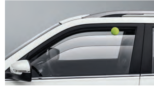
Motoros ablakemelő becsípődésgátló funkcióval a vezető oldalán
